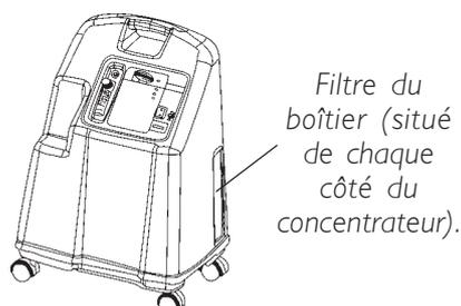
**FIGURE 1 - EMBLACEMENT DES FILTRES DU BOITIER**
